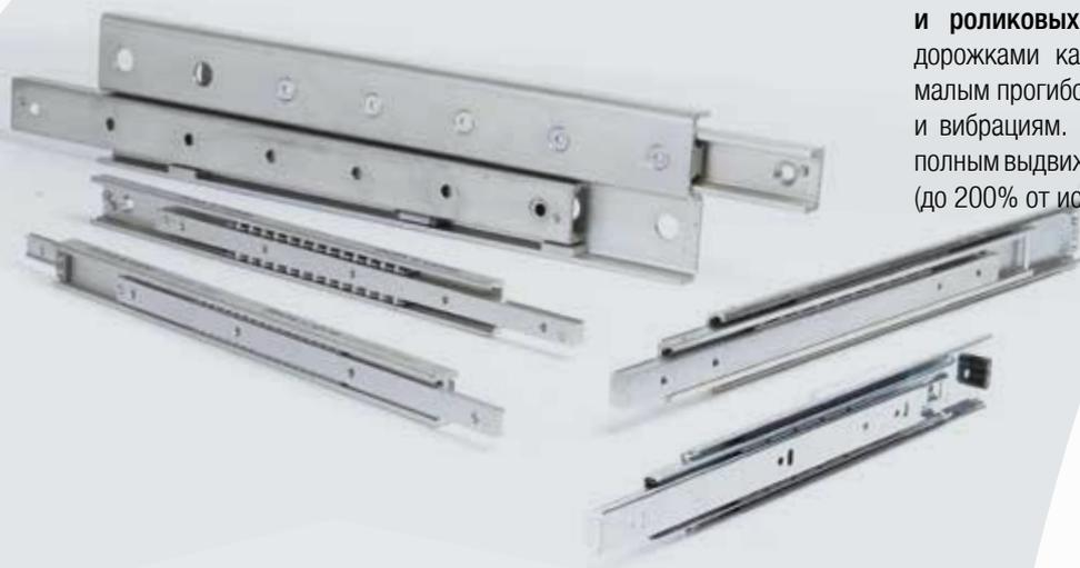
Телескопические направляющие на шариковых и роликовых подшипниках, с упрочнёнными дорожками качения, высокой грузоподъёмностью, малым прогибом, и высокой устойчивостью к ударам и вибрациям. Имеются варианты с частичным или полным выдвиганием, а также со сверхвыдвиганием (до 200% от исходной длины направляющей).
